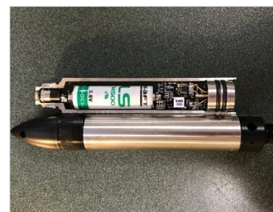
圧力チップの内部構造
