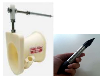
写真8. 排水流量調査(卵形フリーウム式流量計)
