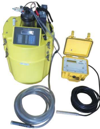
写真5. 水位トリガーによる自動採水システム
